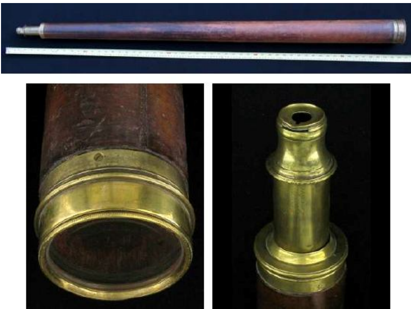
Рис. II: Двухлинзовый ахромат-рефрактор, изготовленный Доллондом приблизительно в последней трети 18 века: а) (сверху) общий вид; б) передний конец телескопа; в) окулярный конец телескопа.
