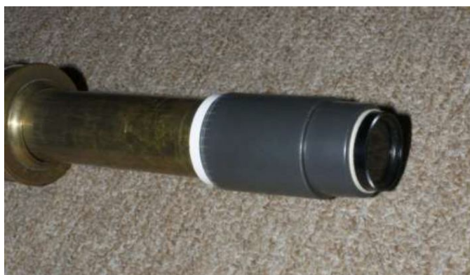
Рис. V: Фильтр переменной плотности, закрепленный на окулярном конце рефрактора №1-АК.
