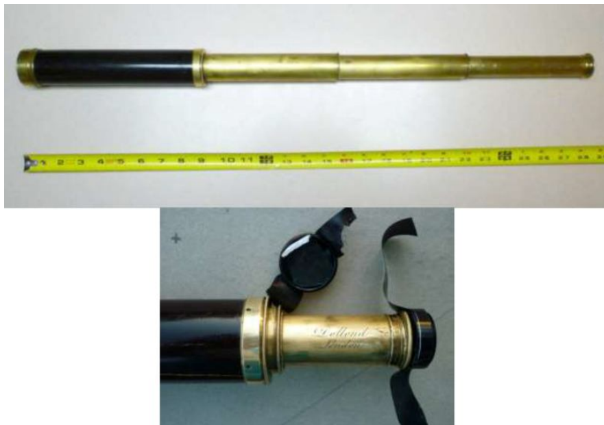
Рис. VI: Двухлинзовый ахромат-рефрактор №2-VS, изготовленный Доллондом приблизительно в конце 18 - начале 19 века: а) общий вид; б) окулярный конец и два закопченных стеклянных фильтра.
